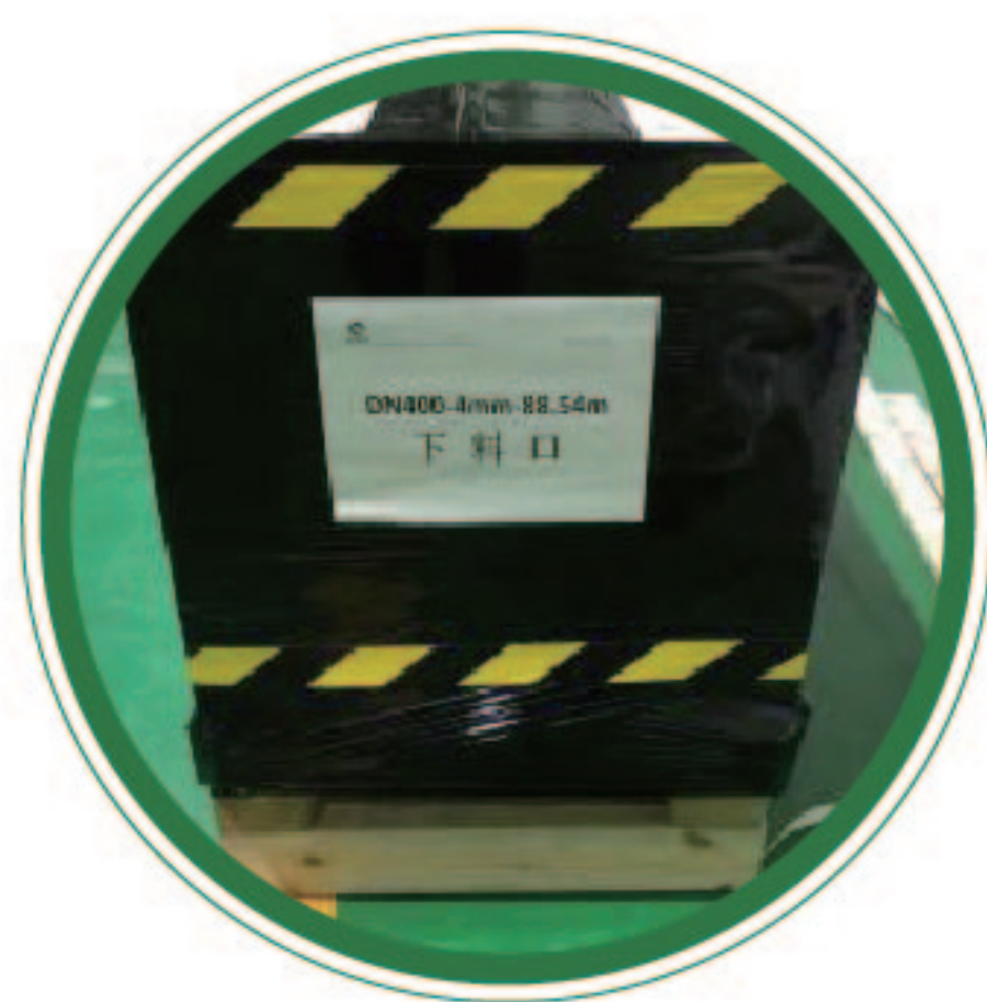
卸货时将木箱下料口对准下料井口， 距离5-6米检查木箱是否完好将木箱贴 有下料口的一端靠于下料井口5-6米处
